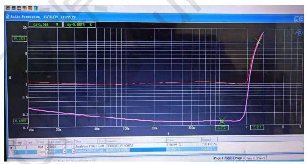
图中上面红色曲线为TC8002D谐波失真+噪声(THD+N)曲线,谐波失真+噪声(THD+N)比较大,基本都在1%以上。用示波器观察,发现该产品存在交越失真的情况。
